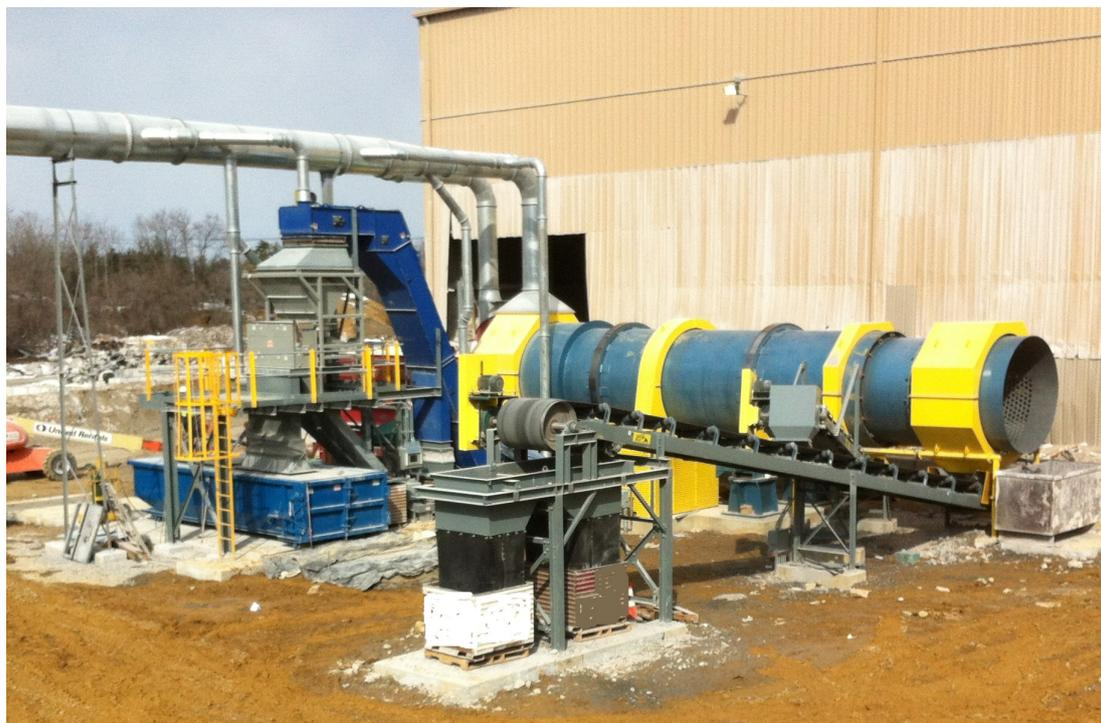
**Figure 1. DIDION RT 108 DIDION Crusher / Metal Separator.**
